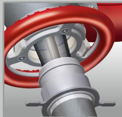
Conexión Empuje-Gire-Cierre ( PTL ): rápido cambio de puntera y control del filtro.
