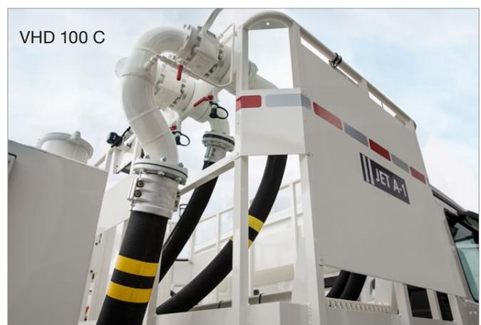
A Elaflex fornece **Mangueras de Abastecimento** de aeronaves HD-C (duas tranças têxteis) e VHD-C (três tranças têxteis) mangueras 'tipo C' de acordo com EN ISO 1825 / EI 1529 por muitos anos. Adequado para uso como mangueras de entrada, tampa e carretel.
