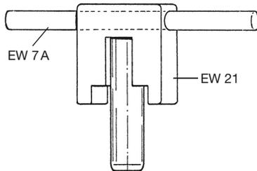
Montagedorn **EW 21** aus Stahl für demontierbare COAX-Schlauchverschraubungen DN 21/V 34. Swivelmutter muss vorher abgenommen werden. Der Querstab **EW 7A** wird gesondert bestellt.
