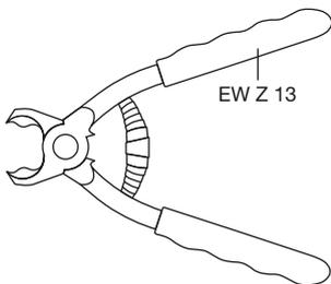
Spezialzange **EW Z 13** für die sichere Montage der Gasschlauchschellen **GSS**.
