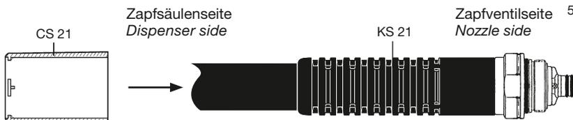
Die Sortentülle **CS 21** wird zur nachträglichen Montage zapfsäulenseitig über die Schlauchverschraubung geschoben. Zapfventilseitige Montage ist nach Abnahme der Swivelmutter möglich.
